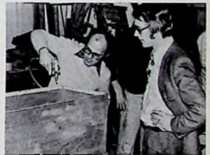
Om de kast hermetisch te sluiten wordt afdichtingskit aangebracht
